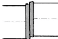
зміщений зварний шов
