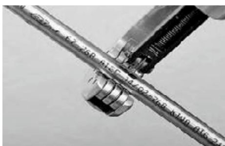
Етап 3 – відмітка глибини вставлення труби в розтруб
