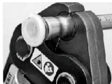
Етап 6 – запресування фітинга за допомогою прескліщів
